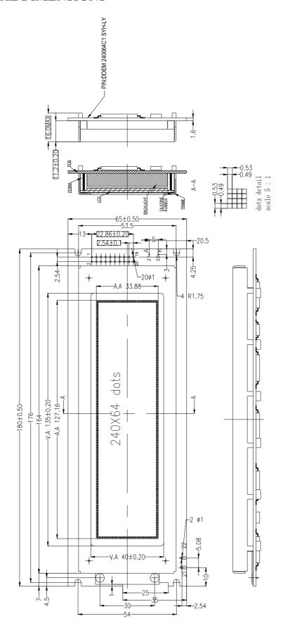
REMARKS: 1,UNMARKED TOLERANCE IS ±0.20 2,MATERIAL COMPLY WITH THE ROHS.
