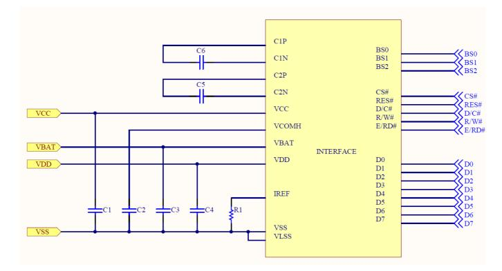
Recommended components : C1, C2 : 2.2uF C3, C4 : 1.0uF
