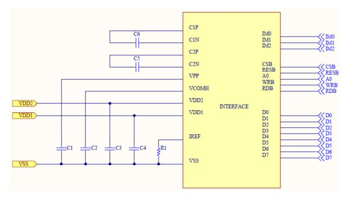
Recommended components : C1, C2, C3, C4 : 4.7uF C5, C6 : 0.22uF
